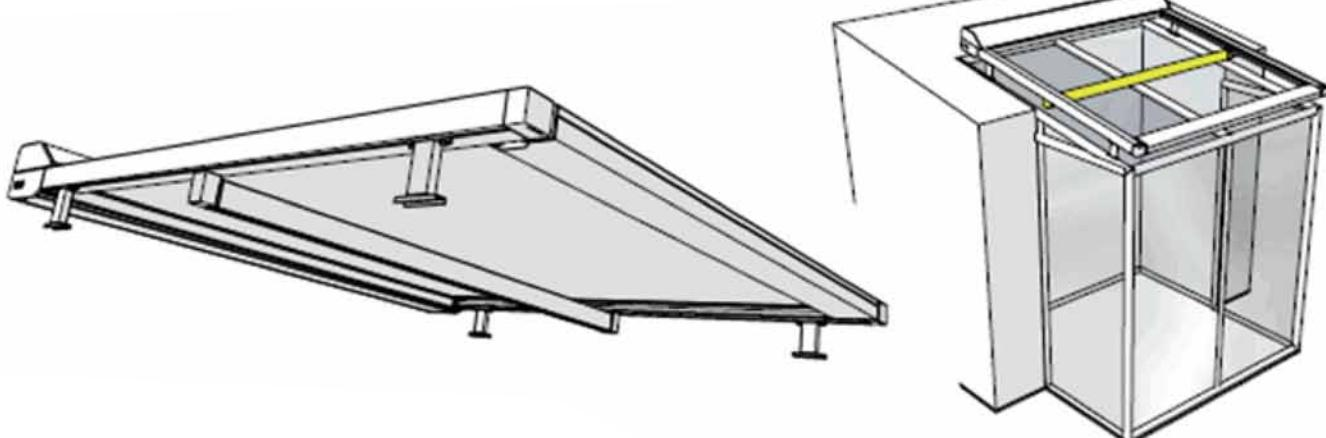
Le profil d'appui est installé toujours dans la position fixe, au milieu des coulisses.
