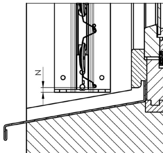
L'écart entre le bord inférieur de la dernière latte et extrémité du guide-chaîne  $N = 10 \pm 5 \text{ mm}$
