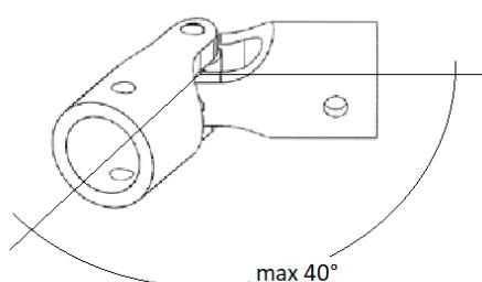
L'angle max. pour un joint est de 0-40 degrés.
