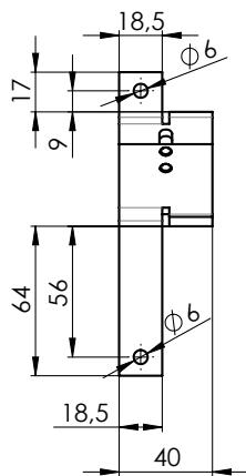
Pour le profil 40x40 mm, la distance minimale entre l'axe du guidage et la surface de fixation est de 70 mm !
