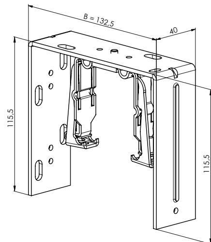
Support-double mécanique - réglable, longe 165 – 223 mm
