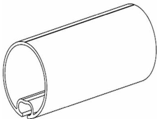
Matériel: aluminium extrudé, (diam. 40, diam. 50 ou 67mm)
