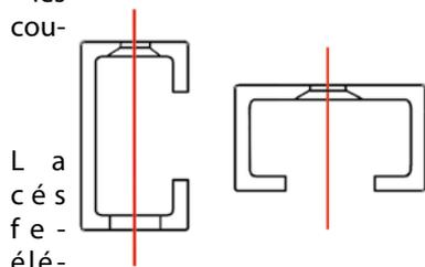
ligne rouge indique l' axe vertical pour les vis de montage. Utiliser les coulisses percomme modèle pour transposer la position des trous sur le mur d' un vantail de la nêtre. Visser les coulisses sur le mur à l' aide des vis et des autres éléments conformes au type de construction sur laquelle on les monte (construction métallique, ciment, brique etc.). Pour le montage frontal de la coulisse, on livre les capuchons autocollants pour couvrir les trous des vis de fixation.
