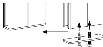
Avec la fin de course de PVC noir ou tôle de finition d'aluminium sur la partie basse pour la fin de course de la barre finale, épaisseur 2mm
