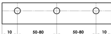
Pour le modèle ZIP, on n'offre qu'un seul modèle de coulisse, c'est GS40. La coulisse est livrée avec les trous prépercés, conformément à la commande, d'un front ou d'un côté.
