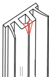
On découpe la coulisse dans le sens longitudinal pour que le bord soit parfaitement rectangle. Après avoir découpé la coulisse intérieur plastique les deux bords supérieurs du profil soient chanfreinés (voir la figure) ce qui empêche l'usure du tissu au niveau d'un bord aigu pendant l'exploitation.
