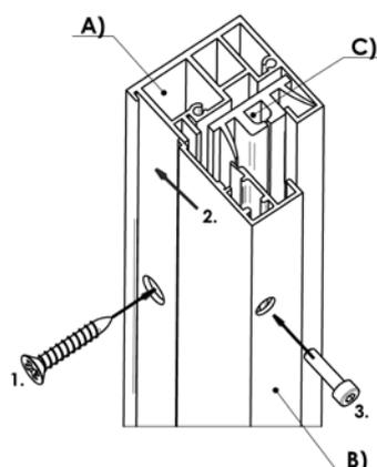
1. Tout d'abord, on fixe la coulisse d'aluminium A) sur le mur.
