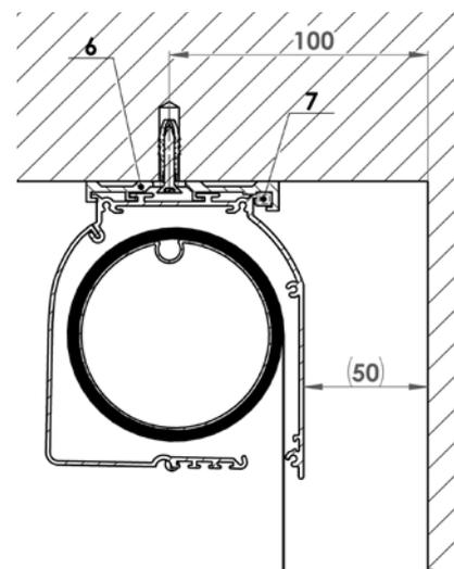
Mettre l'enveloppe supérieure sur les consoles (6) et l'avancer dans le sens longitudinal pour qu'elle soit bien centrée dans le cadre d'un vantail (7) et pousser les coins pour fixer l'enveloppe.
