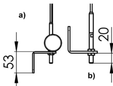
Il est possible de monter les consoles inférieures de manière latérale ou frontale, le profil „L“ peut être orienté vers le bas (a) ou vers le haut (b).
