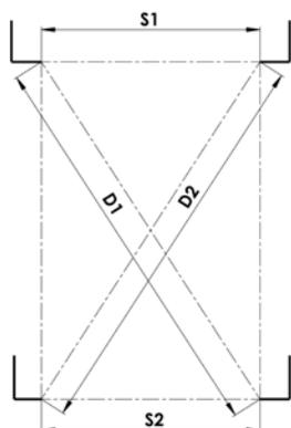
Après avoir achevé le montage il faut contrôler si les coulisses sont parallèles et rectangles. Pour cette raison, il faut mesurer deux distances („S1“ et „S2“) ou les diagonales („D1“ et „D2“). La position conforme des coulisses est nécessaire pour éviter la perturbation des fonctions du store. Pour le montage frontal de la coulisse, on livre les capuchons autocollants pour couvrir les trous des vis de fixation.
