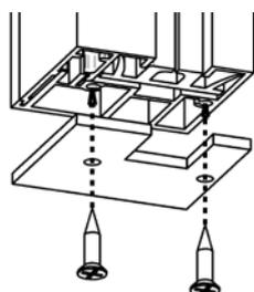
Si le bord d'une coulisse ne se situe pas sur l'allège de la fenêtre ou sur le sol il faut utiliser les capuchons. Avant de continuer le montage il faut visser les capuchons.
