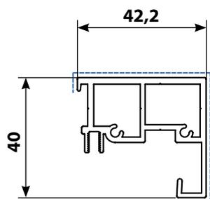
Le procédé correct de montage des coulisses dépend d'un type utilisé d'enveloppe et du fait si l'enveloppe est montée sur le plafond, le mur ou si elle est fixée directement sur les coulisses. On n'offre qu'un seul modèle des coulisses GS40.
