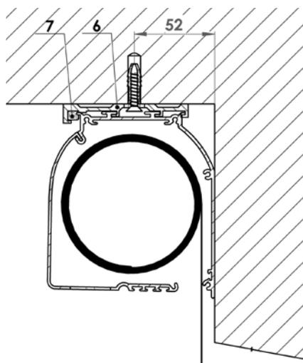
Montez les consoles (6) à l'aide des vis et des éléments conformes au type de construction sur laquelle les consoles sont montées (construction métallique, châssis de la fenêtre, mur ou un autre matériau). Si on utilise trois consoles ou plus, il faut assurer la planéité parfaite des consoles  $\pm 1$  mm ce qu'on peut contrôler en déplaçant l'enveloppe dans le sens des découpes avant de resserrer les vis de fixation.
