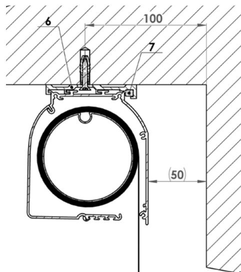
Mettre l'enveloppe supérieure sur les consoles et l'avancer dans le sens longitudinal pour qu'elle soit bien centrée dans le cadre d'un vantail (7) et pousser les coins pour fixer l'enveloppe.
