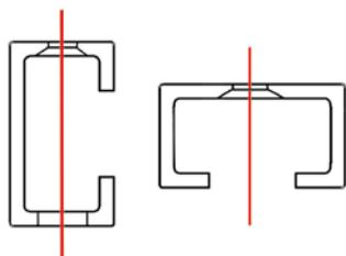
La ligne rouge indique l'axe vertical pour les vis de montage. Utiliser les lardons de guidage percés comme modèle pour transposer la position des trous sur le mur d'un vantail de la fenêtre.
