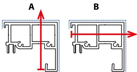
La ligne rouge indique l'axe vertical pour les vis de montage. Utiliser des coulisses percées comme modèle pour transposer la position des trous sur le mur d'un vantail de la fenêtre. Visser les coulisses sur le mur à l'aide des vis et des autres éléments conformes au type de construction sur laquelle on les monte (construction métallique, ciment, brique etc.).
