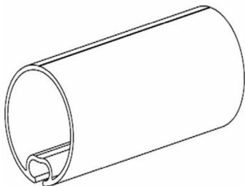
Matière: aluminium extrudé pour tubes Ø 55mm et Ø 67mm et acier galvanisé pour tubes ø 85 mm a ø 100 mm.
