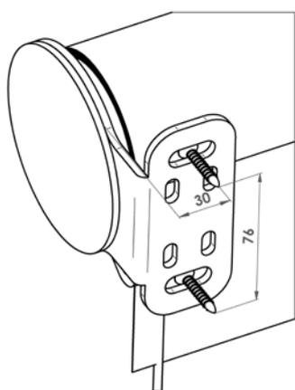
Il faut commencer le montage du store screen par le positionnement des trous de fixation des consoles portantes.
