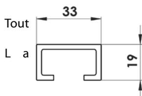
d' abord, monter l' enveloppe sur le plafond /mur, ensuite monter les coulisses. Pour le modèle SCREEN LITE, on n' offre qu' un seul modèle de coulisses, c' est GC20. coulisse est livre avec les trous prépercés, conformément à la commande, d' un front ou d' un côté.
