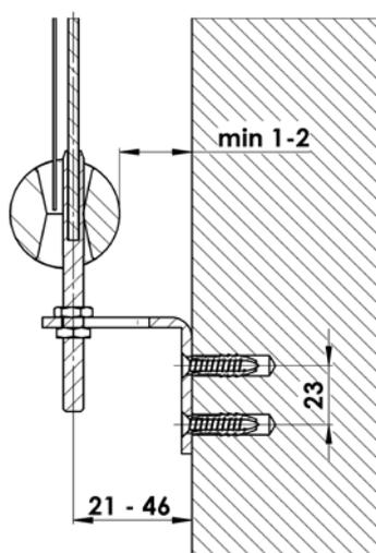
Visser les consoles sur le mur à l'aide des vis et des éléments conformes au type de construction sur laquelle les consoles sont montées (construction métallique, ciment, mur, etc.). Il est nécessaire que la distance entre la barre finale et le mur ou la fenêtre soit de 1-2 mm, au minimum pour éviter la détérioration en marche. Si c'est nécessaire, il faut augmenter la distance entre la console et le mur par les rondelles. Tendre et tenir toujours le cable pur éviter la torsion.
