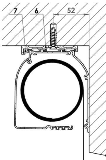
Monter les consoles (6) à l'aide des vis et des éléments conformes au type de construction sur laquelle les consoles sont montées (construction métallique, châssis de la fenêtre, mur ou un autre matériau). Si on utilise quatre consoles, il faut assurer la planéité parfaite des consoles  $\pm 1$  mm ce qu'on peut contrôler en déplaçant l'enveloppe dans le sens des découpes avant de resserrer les vis de fixation.
