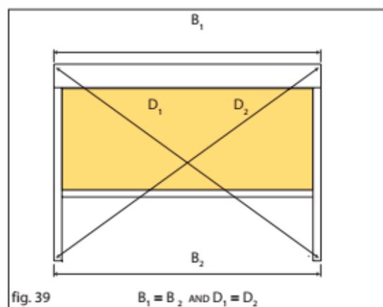
**Méthode 2.** Installation de l'ensemble complet composé du box et des coulisses dans l'ouverture de la fenêtre ou au-dessus et fixation par les vis (utilisée lorsqu'il n'y a pas de place pour emboîter les coulisses sur l'axe de la cloison latérale, par exemple, à cause d'un mur d'appui, ou pour la réalisation autoportante du store screen).
