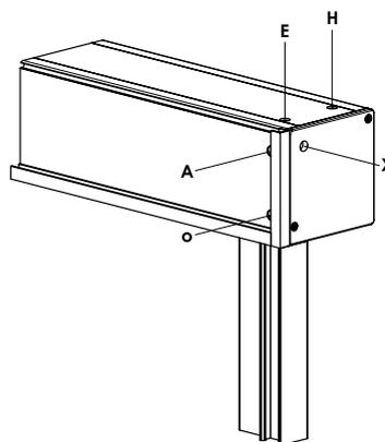
À gauche, sortie X (d'un joue) seulement pour box 110 et 150À droite, sortie X (d'un joue) seulement pour box 110 et 150
