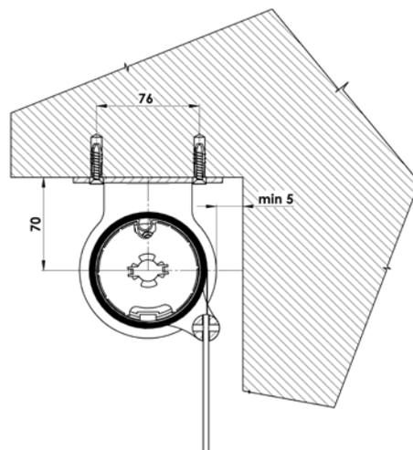
L'enveloppe est montée côté moteur sur le support HiPro (7) et bloquée par un clip, côté inverse, on la met dans la douille plastique (12) et bloque par une vis.
