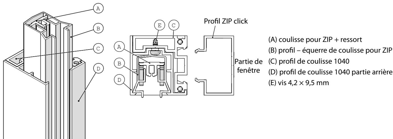
Les larges coulisses complètes 1040 se composent de profil de base (C), profil arrière (D) et support (B) avec le profil ZIP (A). Sur le côté bas de la partie de base de chaque coulisse est la terminaison en aluminium. Le profil arrière est fixé au profil de base de coulisse à l'aide des vis (voir dessin 7b). Le support et profil de ZIP peut être mis, seulement si le profil arrière est fixé, car ils sont de 35 mm plus longues que la coulisse.
