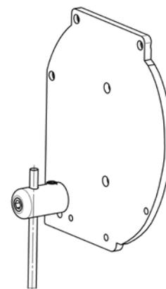
Visser les consoles sur le mur à l' aide des vis et des éléments conformes au type de construction sur laquelle les consoles sont montées (construction métallique, ciment, mur, etc.). Si c' est nécessaire, il faut augmenter la distance entre la console et le mur par les rondelles. Tendre et tenir toujours le cable pur éviter la torsion.
