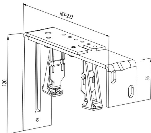
Support-double mécanique - fixe 132,5 mm
