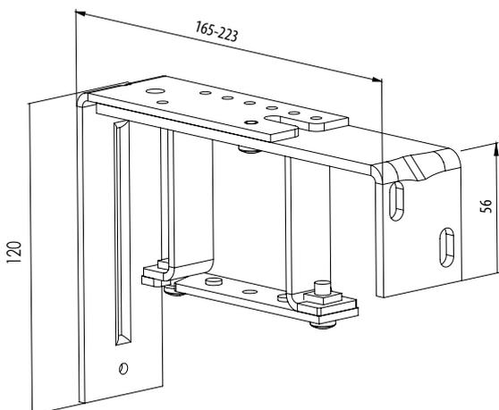
Support double - fixe avec support en aluminium 132,5 mm
