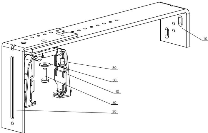
Support réglable double - mécanique 206 – 268 mm
