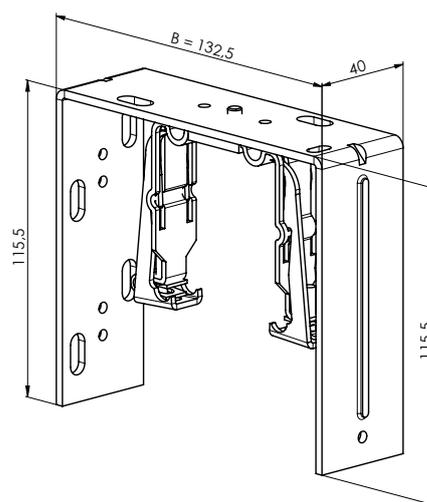
Support-double mécanique - réglable, court 106-163 mm
