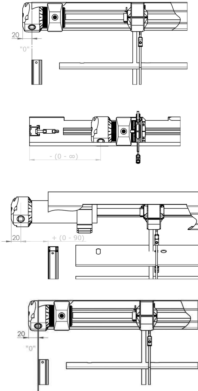
La position du treuil (déplacement possible) du boîtier dépend de l'emplacement concret du cadre de la fenêtre, de l'embrasure. La décalage du treuil est la distance de l'axe de boîtier de réduction du bord extérieur de la lame dans le cas de commande par la câble en acier.
