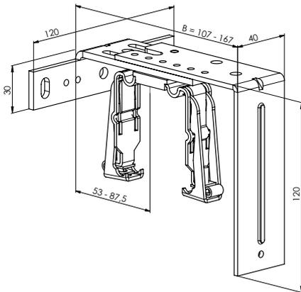
Support réglable - mécanique 162 - 222 mm
