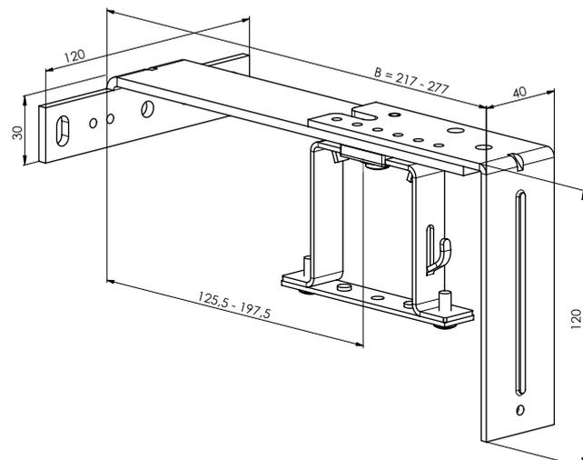
Support réglable - mécanique 206 – 268 mm
