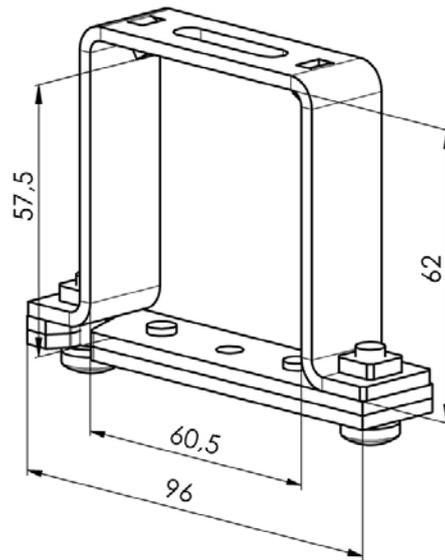
Étrier du boîtier FE pour guidage par câble (2-00685)
