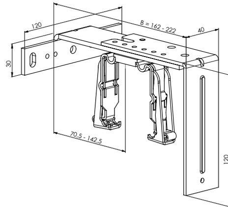
Support réglable - mécanique 217 - 277 mm
