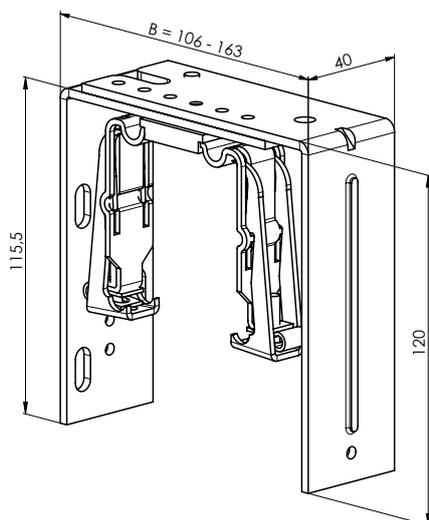
Support-double mécanique - réglable, longue 165 - 223 mm
