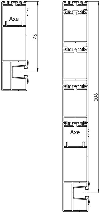
Profil de base P 080 Élargissement maximale de profil de base P 080
