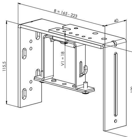
Support réglable - mécanique 107 - 167 mm
