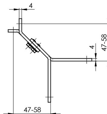
Pour le profil 40x40 mm, la distance minimale entre l'axe du guidage et la surface de fixation est de 70 mm !
