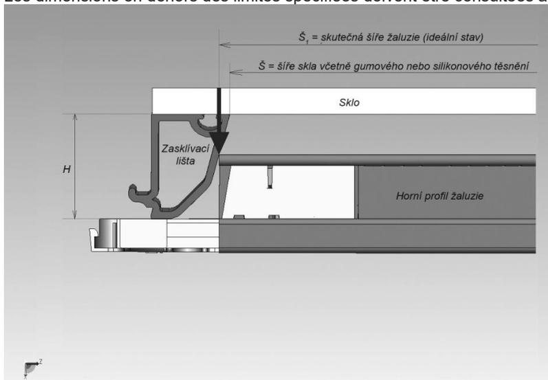
La photo montre l'orientation idéale du store. Une telle mesure peut être réalisée en utilisant une section transversale du boîtier avec une plaque latérale, où en plaçant le dispositif sur le parclose, il est possible de déterminer le point, la largeur maximale possible du store et à partir de ce point, mesurer la dimension au même point du côté opposé. Cette focalisation est toujours influencée par la forme et la taille du vitrage de profil de fenêtre.
